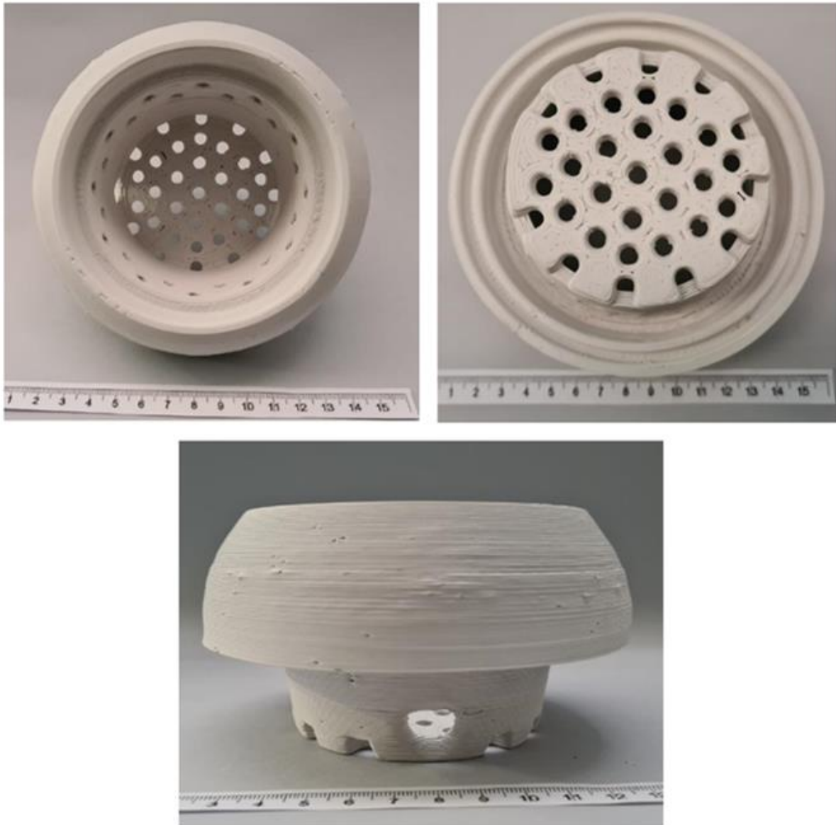
Figura 5 – Braciere in tialite, sinterizzato, prodotto da stampa 3D LDM, con pasta ceramica ottimizzata presso ENEA-Laboratori di ricerca di Faenza
